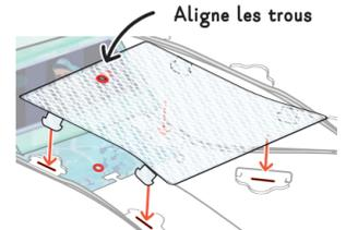
5 Glisse les languettes du filet dans les fentes des coques.
